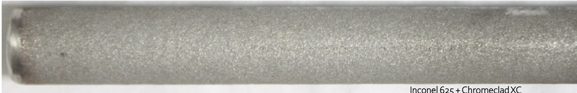
Inconel 625 + Chromeclad XC 2,1 – 2,3 mm weld overlay ca. 600 - 700 µm Arc-Spray
