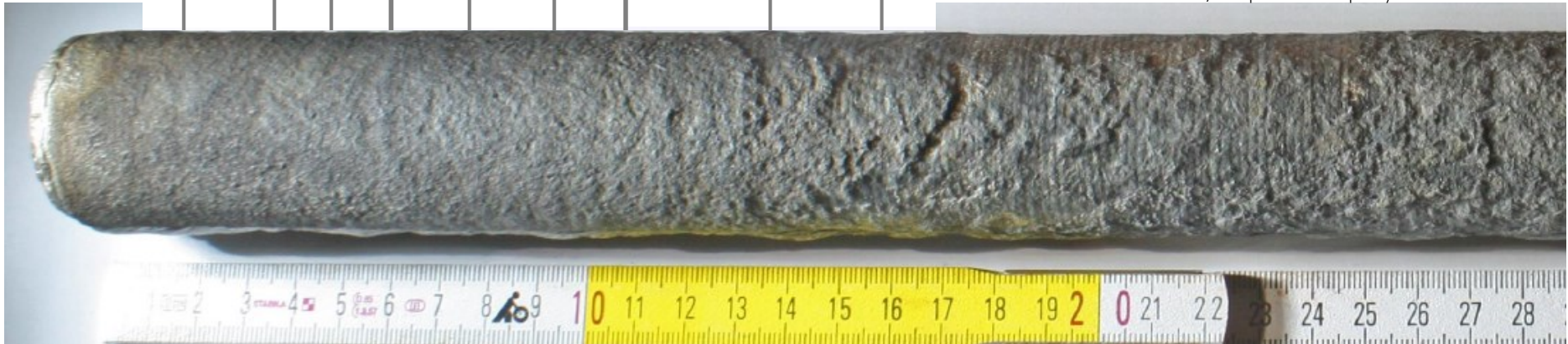
Inconel 625 + Chromeclad XC 2,1 – 2,3 mm weld overlay ca. 600 - 700 µm Arc-Spray
